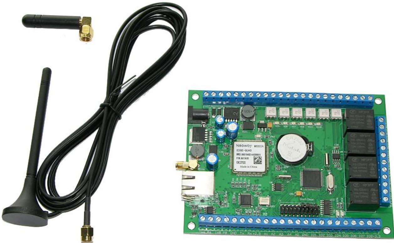
Рис. GSM антенна KG-25 (вверху, слева) и KG-50-3 (внизу, слева)
