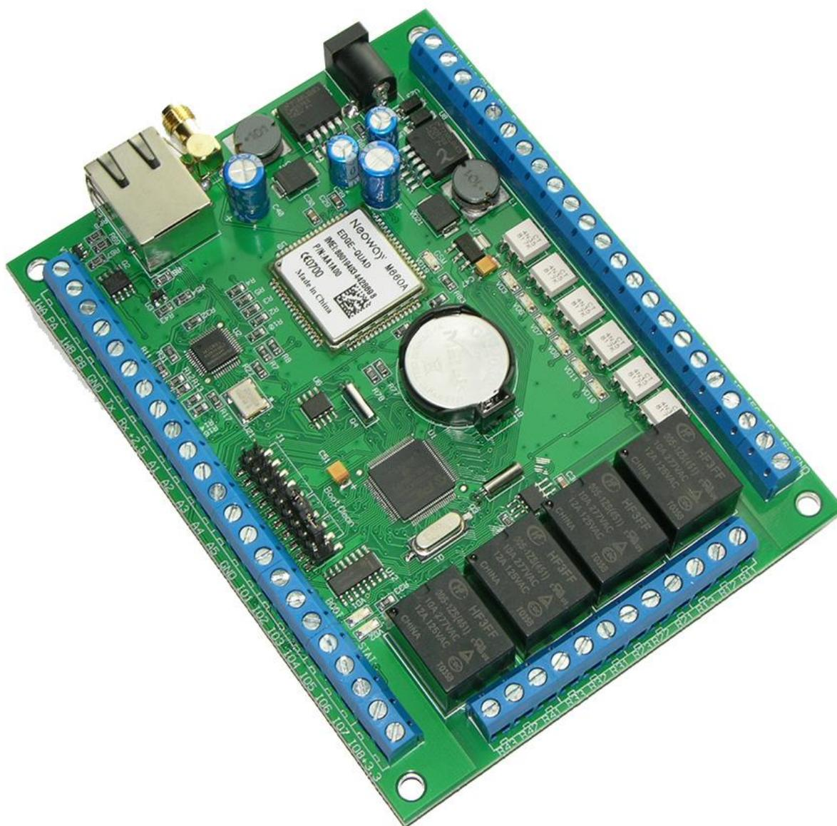
Рис.2. Общий вид модуля Laurent-5G (установлен GSM модем)
