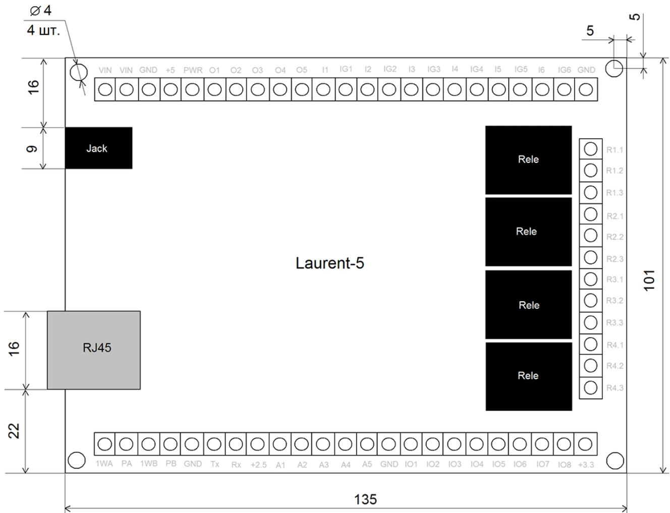
Рис. Габаритные размеры модуля Laurent-5
