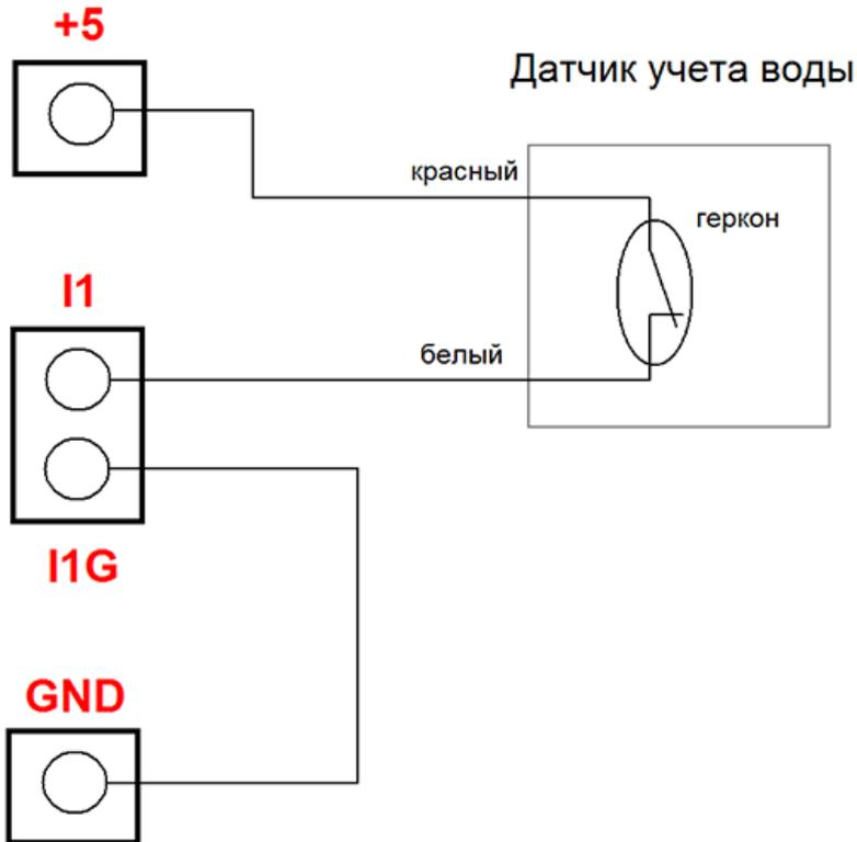
Рис. Схема подключения счетчика воды с импульсным выходом к входной оптоизолированной линии IN\_1 для подсчета входящих импульсов которые можно будет пересчитать в расход воды в м<sup>3</sup>
