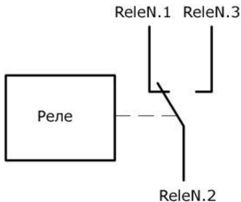
Рис. Состояние контактов реле по умолчанию (реле выключено)
