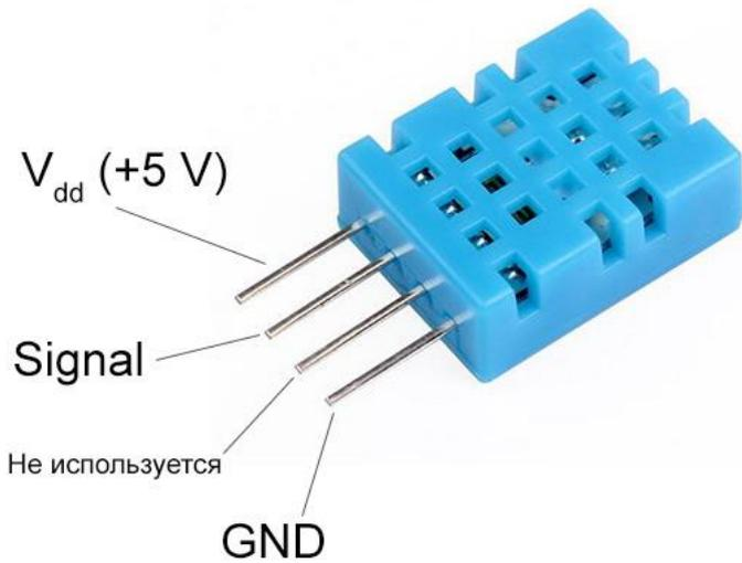
Рис. “Распиновка” датчика влажности DHT11. Датчик DHT-22 имеет аналогичную распиновку.
