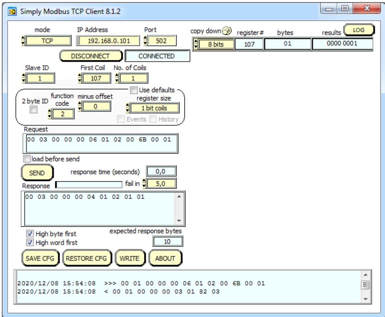
Рис. Пример формирования запроса в окне программы Simply ModbusTCP Client.
