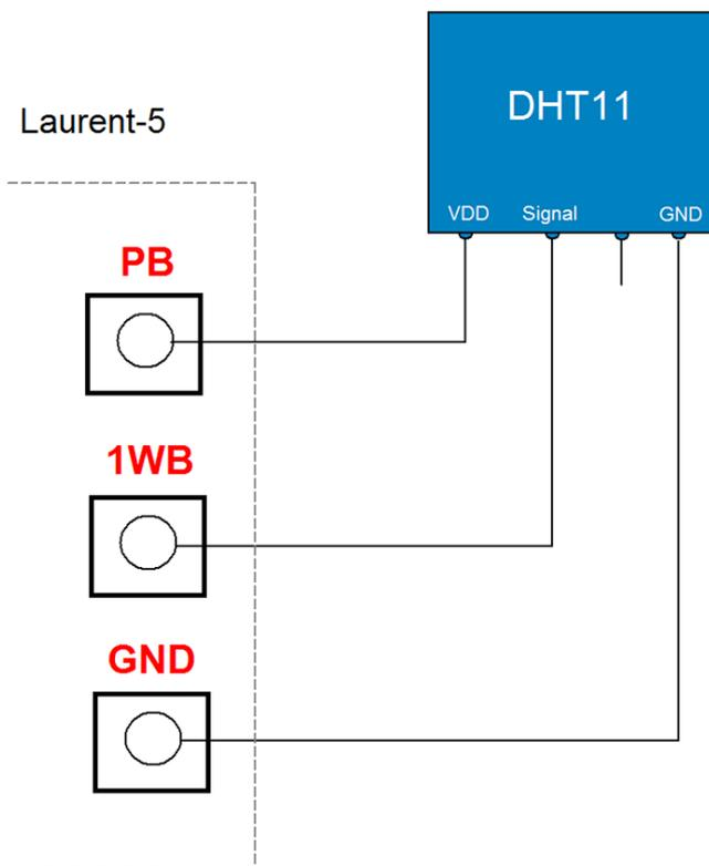
Рис. Типовая Схема подключения датчика DHT-11 / DHT-22 к каналу ‘В’ шины I-Wire модуля Laurent-5 / 5G.
