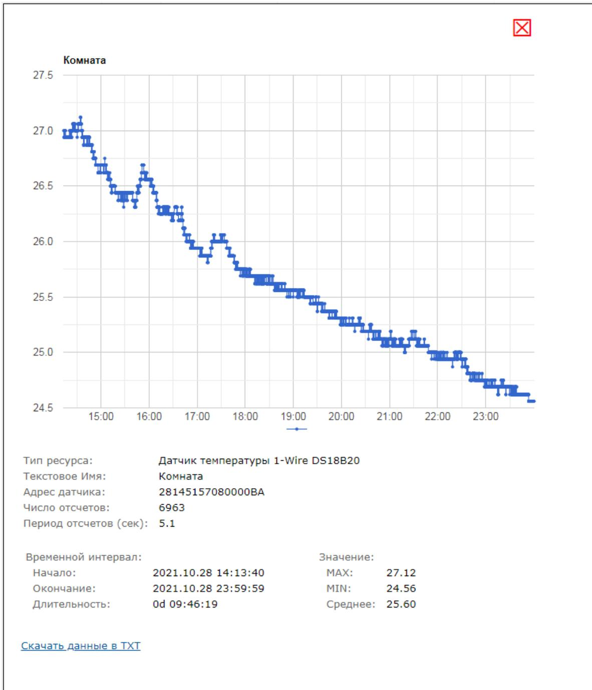
Данные можно так же скачать в текстовом виде (время – показание датчика) для последующего анализа или дополнительной обработки (например, в Excel).
