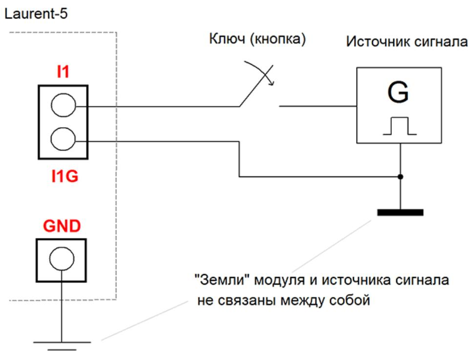
Рис. Источник сигнала для входной линии IN\_1 “развязан” относительно самой платы (ее источника питания).
