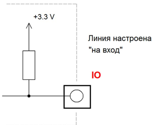
Если к линии IO настроенной “на вход” подключить через GND механический датчик разрыва цепи или любую кнопку то в разомкнутом состоянии на линии будет высокий логический уровень, при замкнутом – низкий (линия “подтянута” к “земле”). Детектируя факт изменения уровня сигнала с помощью системы [CAT](#) можно построить автоматизированную логику обработки такого события и выполнить необходимые действия (например, включить реле).
