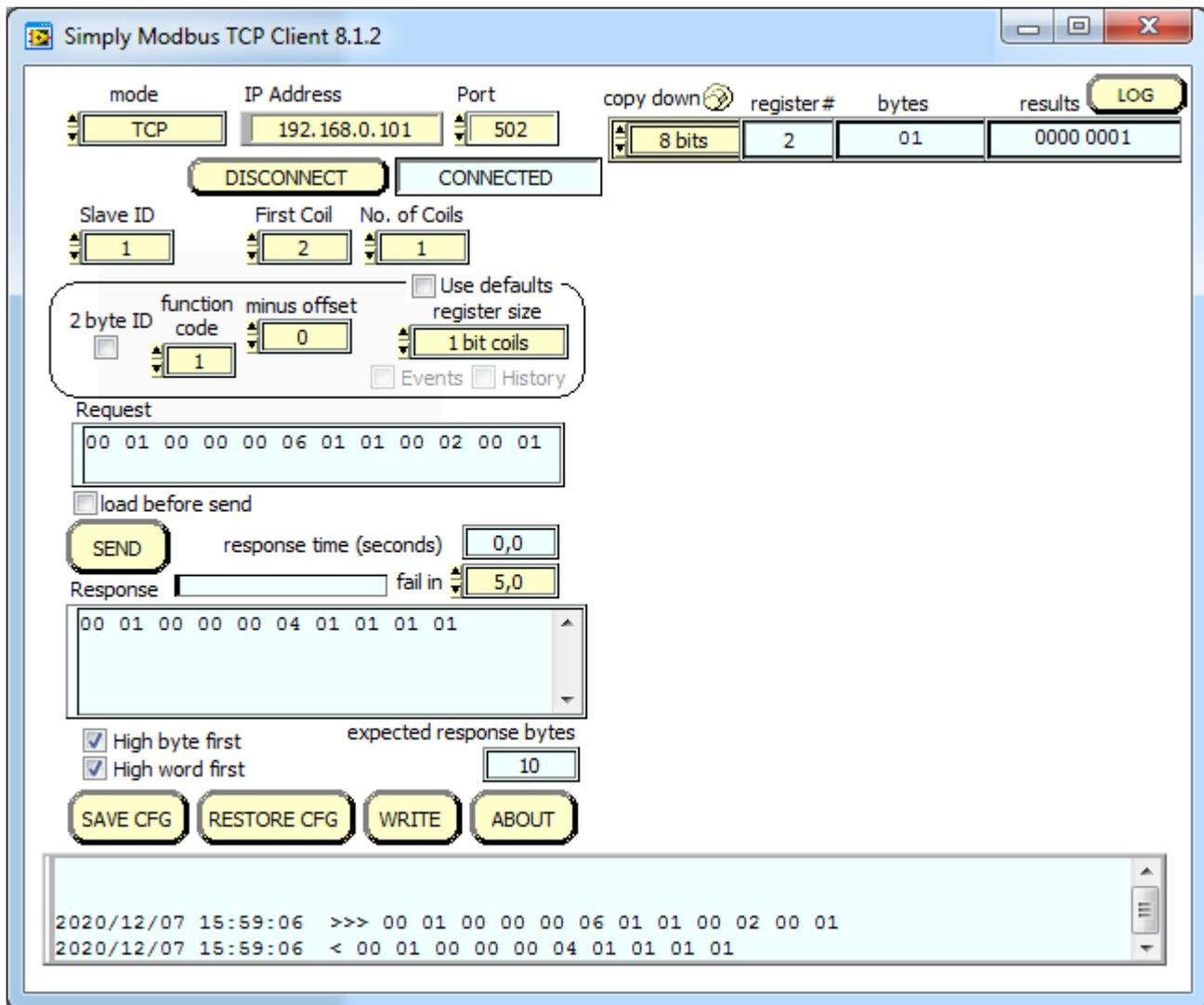
Рис. Пример формирования данного запроса в окне программы Simply ModbusTCP Client.
