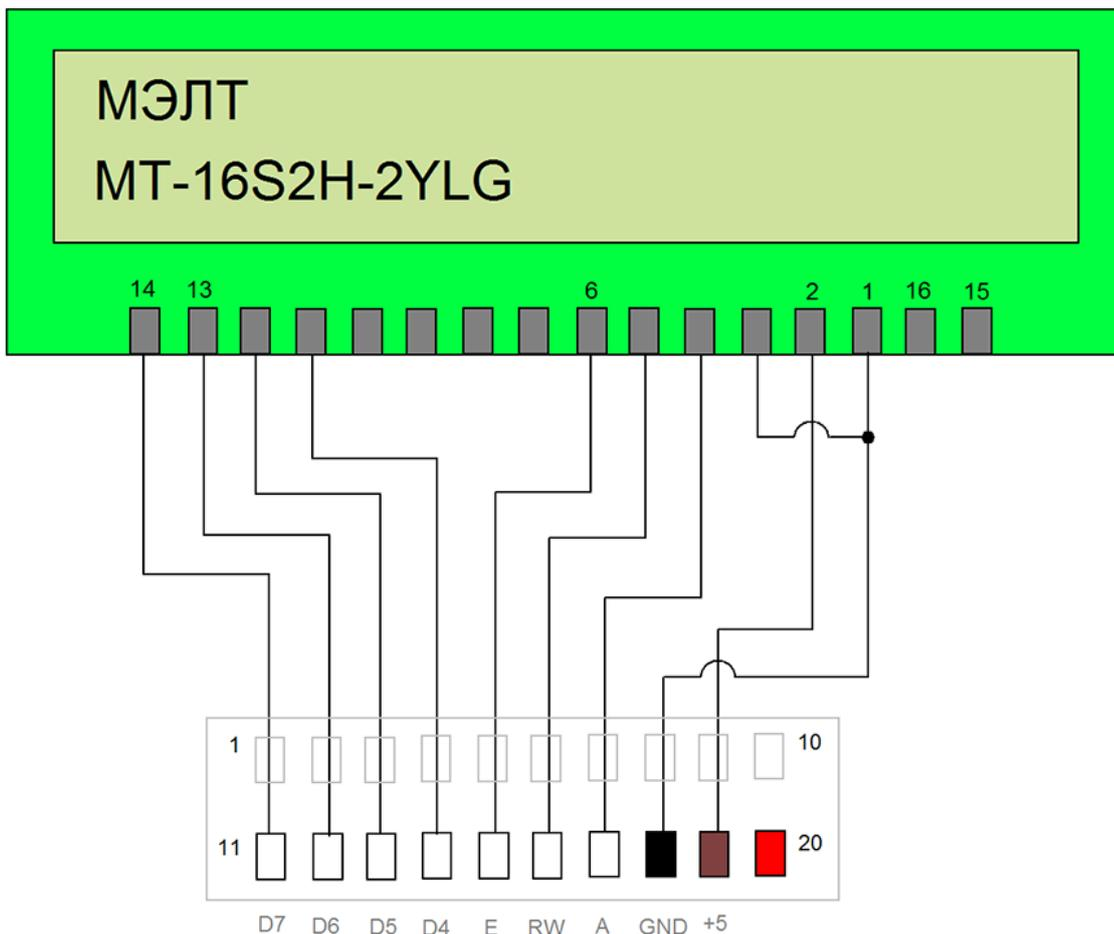
Рис. Схема подключения LCD дисплея MT-16S2H-2YLG к “штырьковому” разъему J1 (вид сверху) модуля Laurent-5 / 5G. Питание дисплея +5 В.
