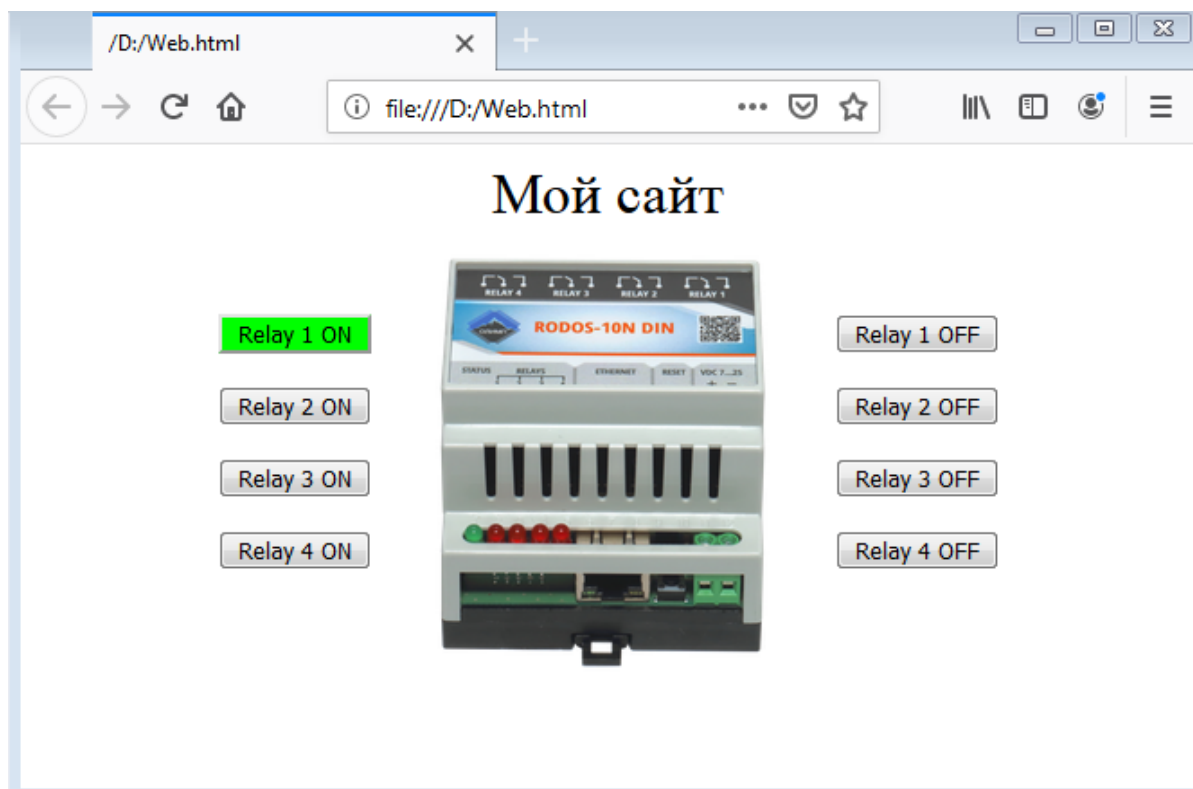
Рисунок 3 – внедрение элементов управления реле на пользовательский сайт
