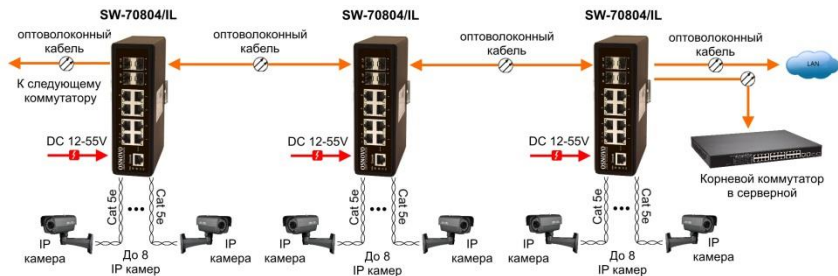
Рис.6 Типовая схема подключения коммутатора на примере SW-70804/IL
