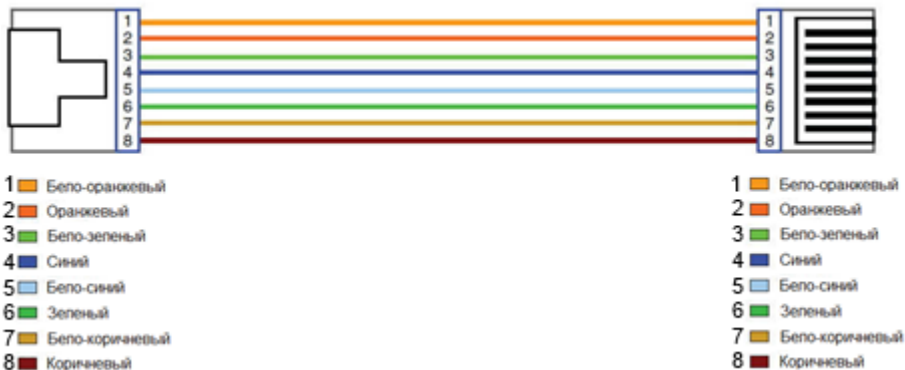
Рис. 10 Разводка кабеля по типу TIA/EIA-568-A.
