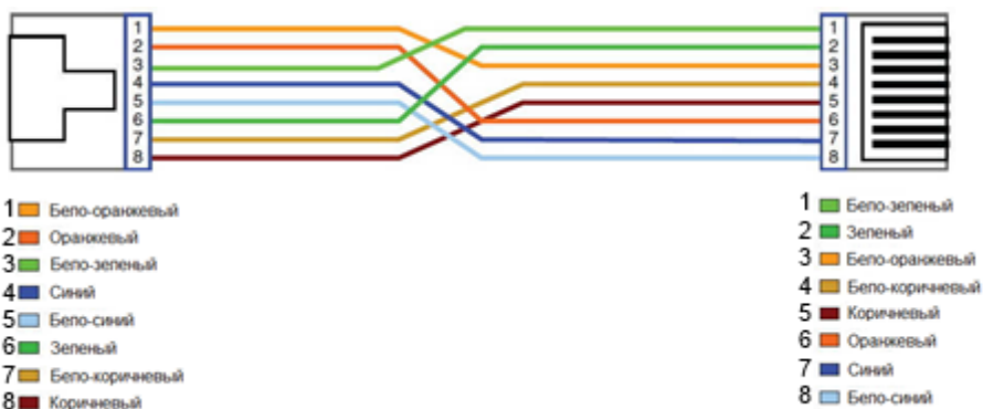
Рис. 12 Разводка кабеля по типу TIA/EIA-568-B.
