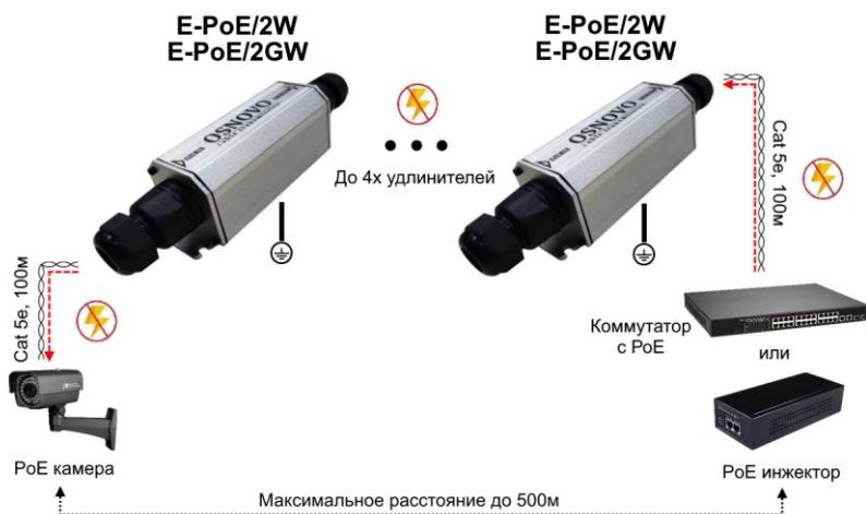
Рис.3 Схема подключения удлинителей E-PoE/2W, E-PoE/2GW
