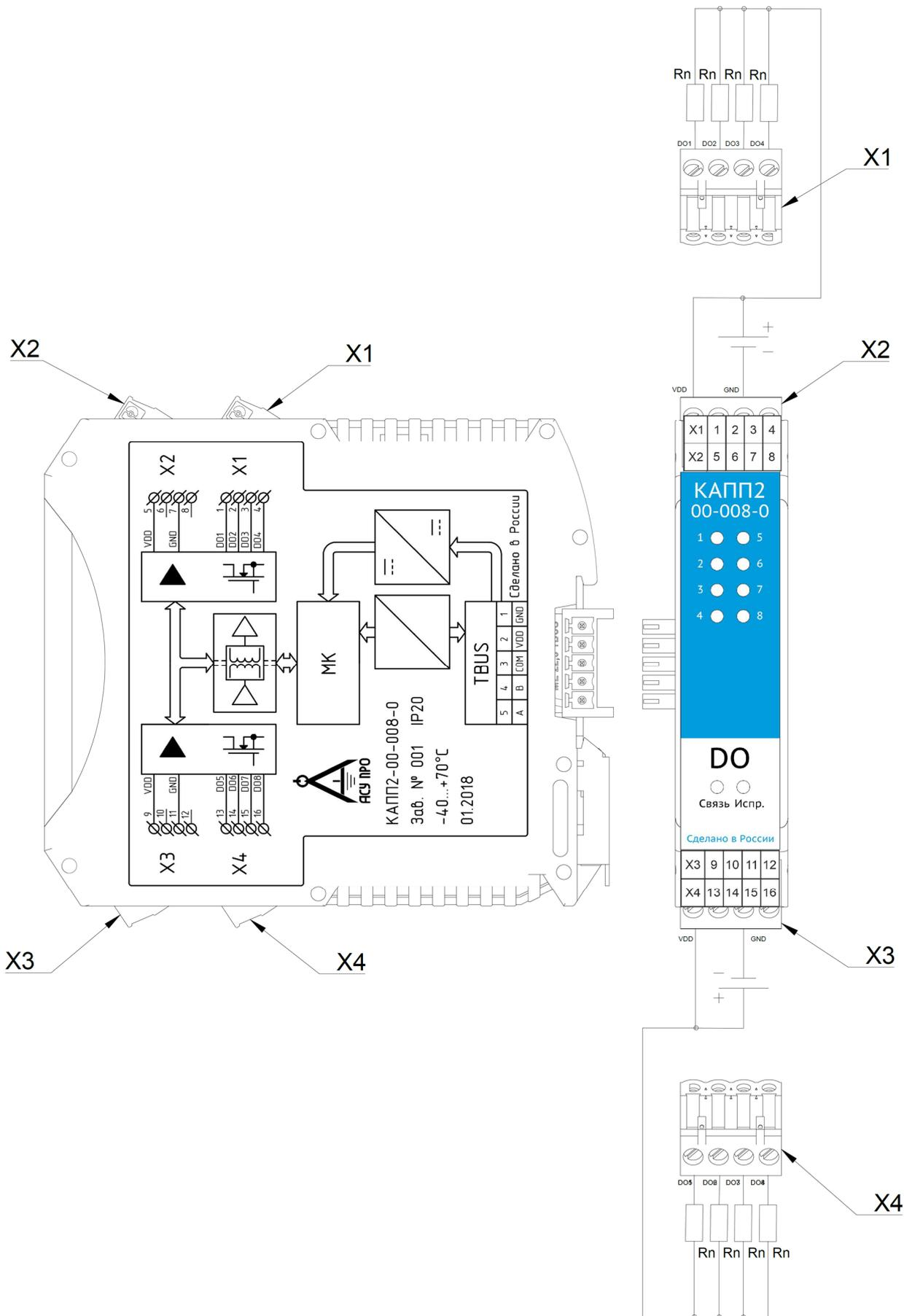
Рисунок 2 – Схема соединений модуля КАПП2-00-008-0
